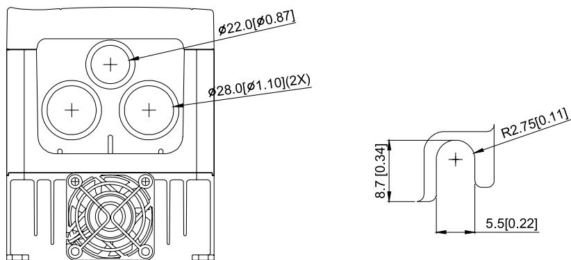
**Типоразмер В:** VFD022B21A, VFD037B23A/43A/53A
