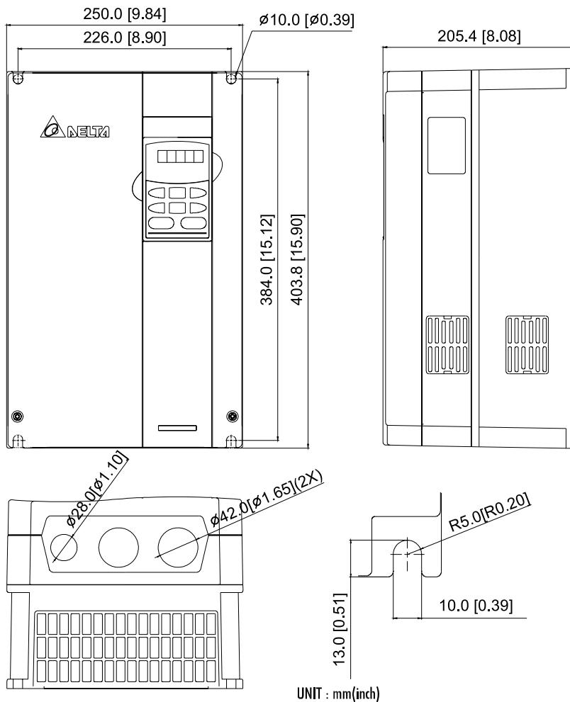
Типоразмер E: VFD300B43A/53A, VFD370B43A/53A, VFD450B43A/53A
