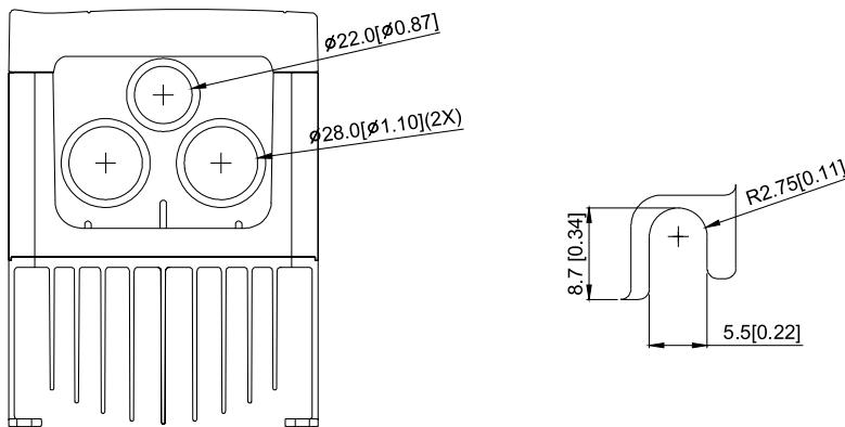
Типоразмер А2: VFD015B21B/23B, VFD022B23B/43B/53A
