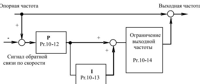
Блок-схема управления скоростью с помощью ПИД-регулятора.
