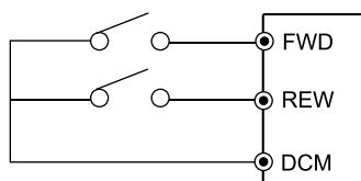
Задайте требуемую частоту вращения потенциометром, замкните контакт на терминале FWD и двигатель начнет вращаться. Разомкните контакт на терминале FWD – двигатель остановится. Частоту вращения двигателя можно изменять во время вращения двигателя.
