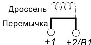
Дроссель в звене постоянного тока используется для фильтрации гармоник в потребляющем от сети токе, увеличении коэффициента мощности, защите от кратковременной асимметрии фаз источника питающего напряжения и других случаях. Перед подключением дросселя снимите перемычку с клемм [+1, +2].
