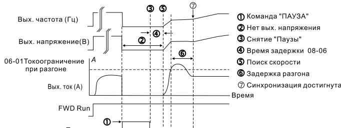
Рис 3: Поиск скорости с минимального значения частоты
