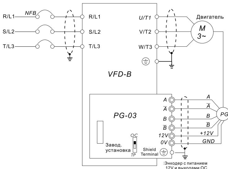
2. Схема соединений с прибором индикации скорости двигателя (RPM meter).
