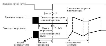
**11 и 12:** Увеличение и соответственно уменьшение ведущей частоты. Многофункциональные входные терминалы: M1 (Pr. 4-04), M2 (Pr. 4-05), M3 (Pr. 4-06), M4 (Pr. 4-07), M5 (Pr. 4-08), M6 (4-09) программируются на выполнение функций увеличения/уменьшения частоты при каждом поступлении команды.
