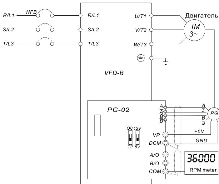
3. Схема соединений при использовании энкодера с выходом типа открытый коллектор.
