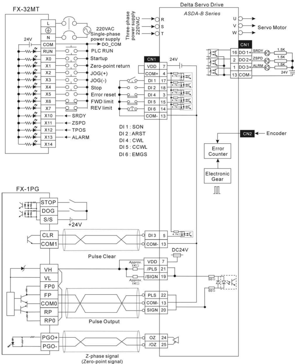
■ Подключение контроллера Mitsubishi FX2N1PG и сервопривода ASDA-B.
