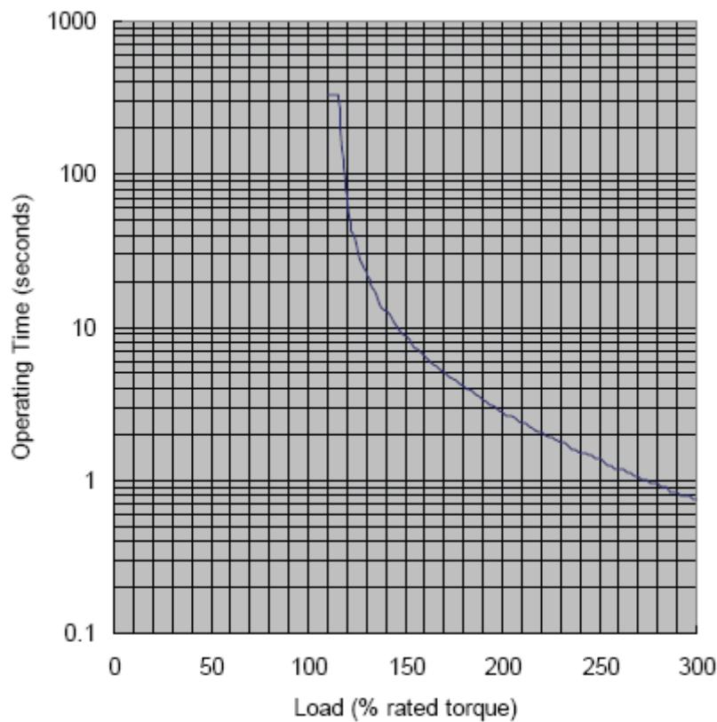
■ Зависимость времени работы от уровня перегрузки (ECMAC30804xS)
