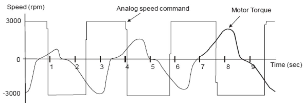
При аналоговом задании S – фильтр обеспечивает плавность изменения сигнала задания скорости и эта функция аналогична формированию S – характеристики. Из показанной диаграммы видно различие между формой входного сигнала задания и кривой формируемой после обработки с помощью S- фильтра. Необходимый уровень подбирается параметрами P1-34, P1-35, P1-36 в зависимости от предъявляемых требований задачи.
