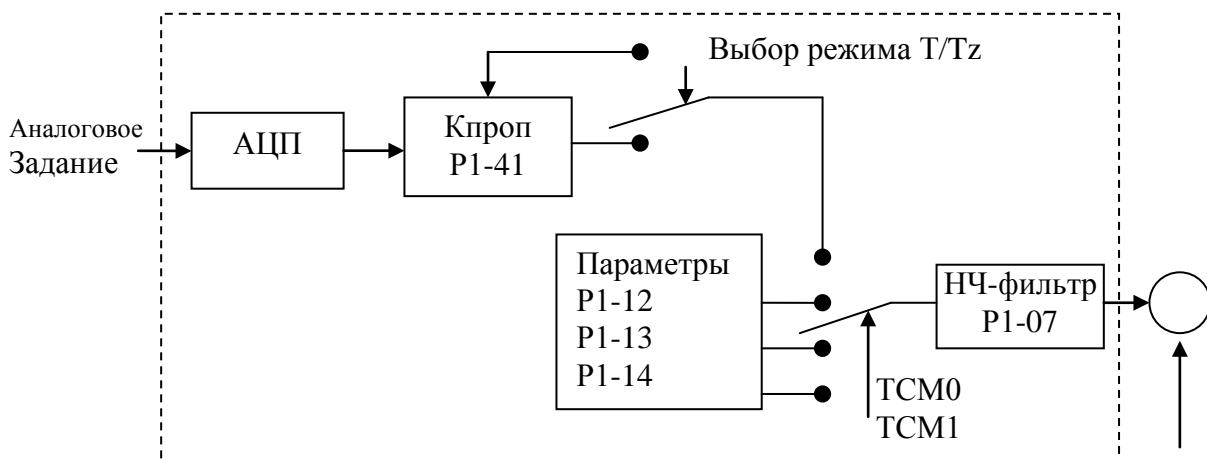
Источник задания момента определяется сигналами TCM0, TCM1 и параметром P1-01 (режим работы Т или Tz). При необходимости сглаживания сигнала задания рекомендуется использовать коэффициент пропорциональности и НЧ – фильтр.
