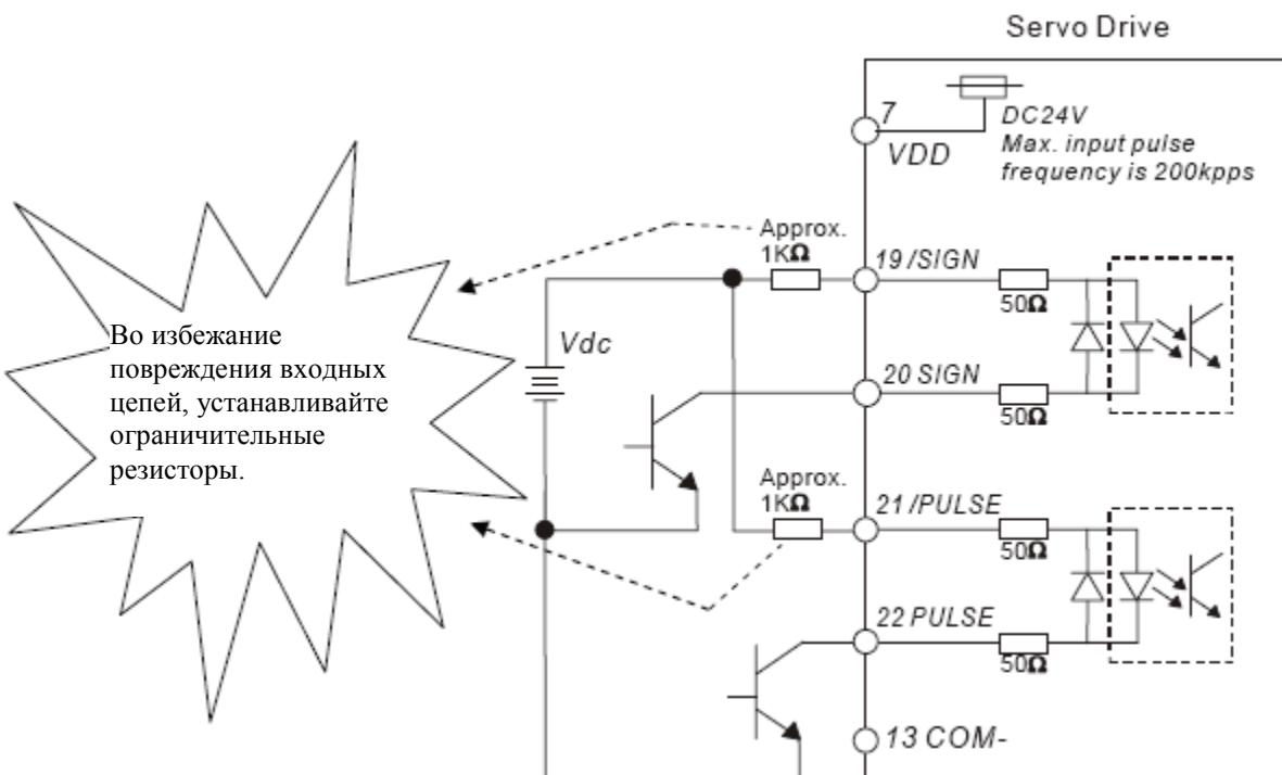
**Схема С3:** Подключение внешних импульсных сигналов типа «линейный драйвер».
