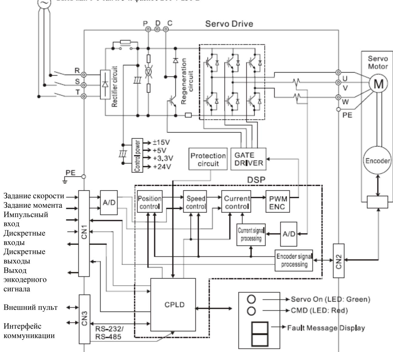
Рисунок 3.5 Схема подключения для моделей мощностью на 750 Вт и выше (модели имеют встроенный тормозной резистор).
