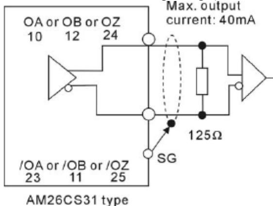
**Схема 13:** Выходные сигналы энкодера (тип сигнала «оптопары»)
