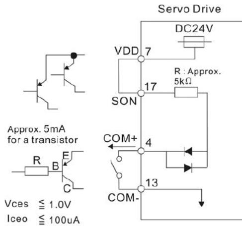
**Схема 11:** Подключение входных сигналов с использованием внешнего источника питания
