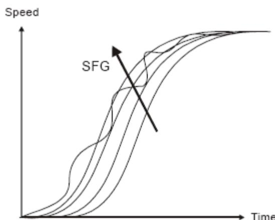
При повышении коэффициента до 1 (100%) уменьшается динамическая ошибка отслеживания траектории заданного сигнала. При большом значении коэффициента возможно появление вибрации и резонанса.
