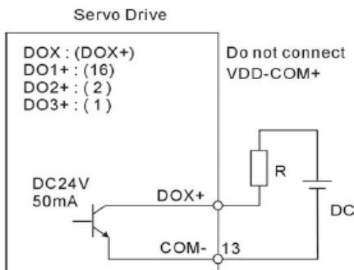
**Схема С7:** подключение выхода к индуктивной нагрузке с внешним питанием.
