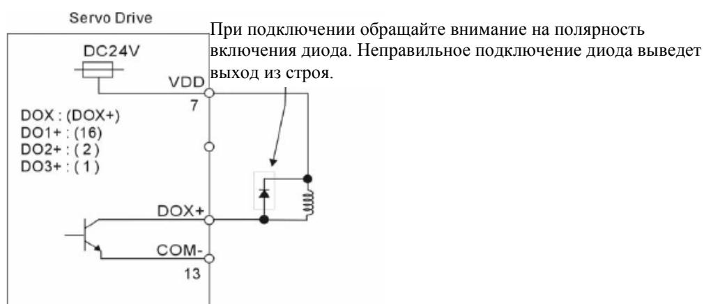
**Схема С6:** Подключение выхода к нагрузке с внешним питанием.
