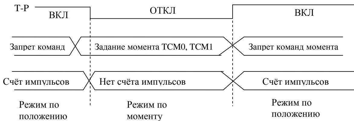
При подаче сигнала Т-Р, активным становится режим по положению, и двигатель работает в соответствии с входным импульсным сигналом. При отключении сигнала Т-Р подсчет импульсов прекращается, происходит переход в режим управления моментом в соответствии с сигналами TCM0, TCM1. После повторного включения сигнала Т-Р происходит немедленный переход в режим позиционирования.
