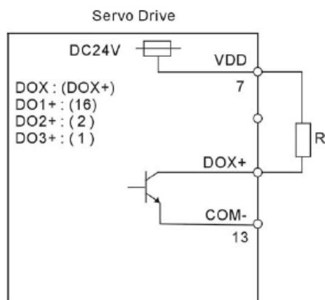
**Схема С5:** Подключение выходов с внутренним источником питания, индуктивная нагрузка.
