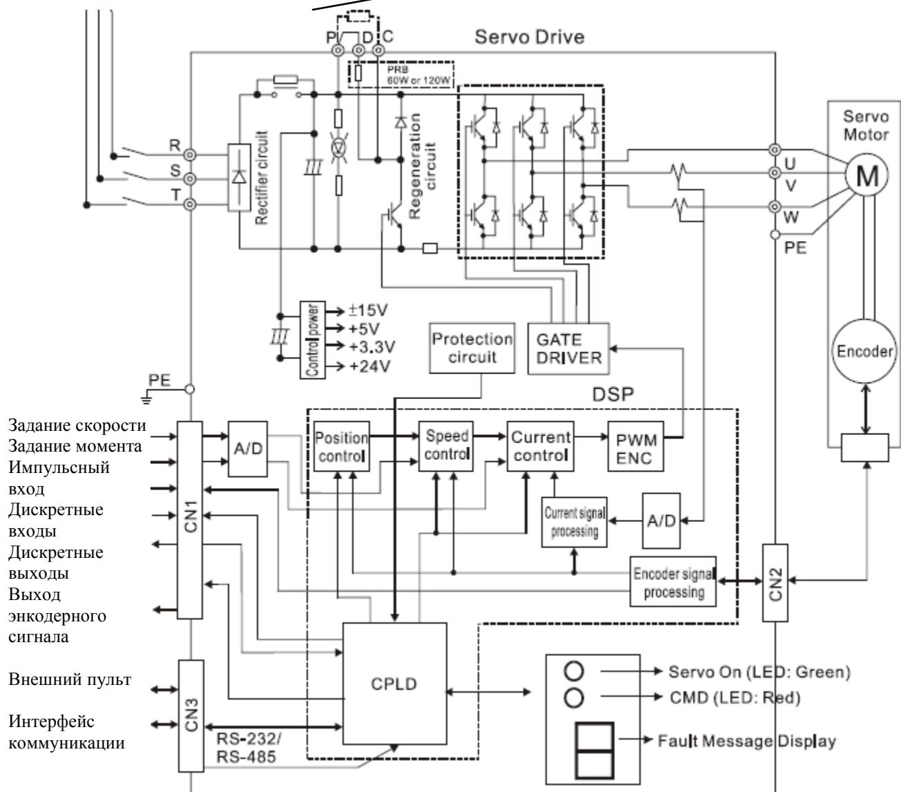
Рисунок 3.6 Схема подключения для моделей мощностью 1 кВт и выше (модели имеют встроенный тормозной резистор и вентилятор охлаждения).
