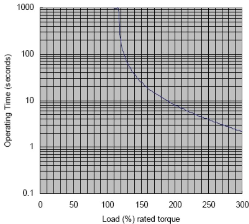
■ Зависимость времени работы от уровня перегрузки (ECMAC31820xS)
