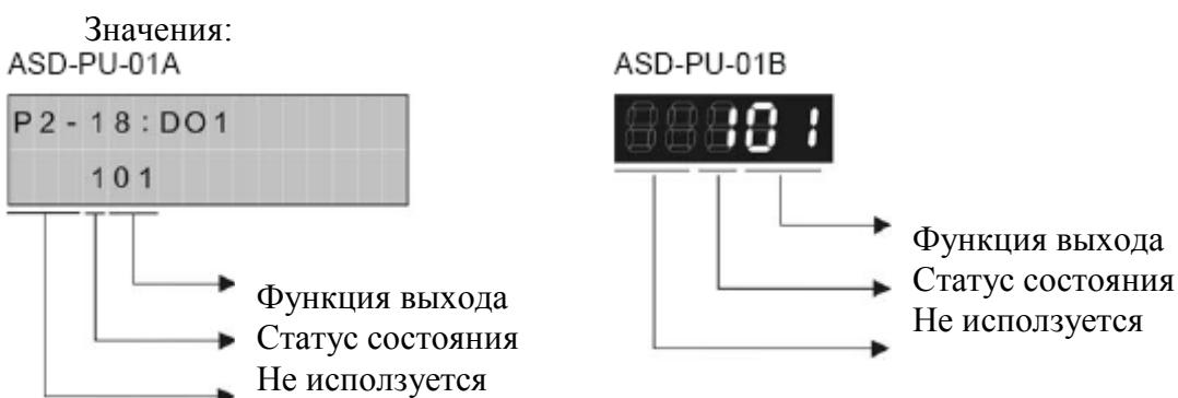
Параметр определяет назначение дискретного выхода DO1
