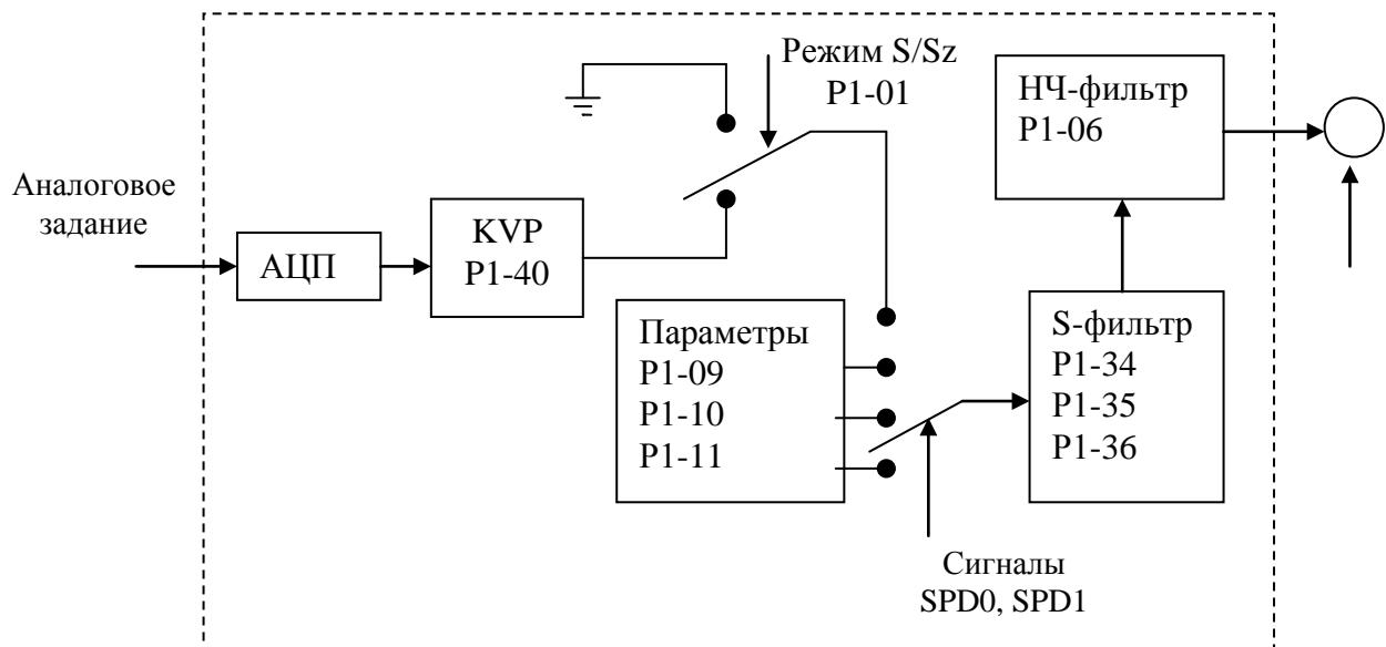
Источник сигнала задания скорости выбирается сигналами SPD0 и SPD1 и выбором режима (параметром P1-01) S или Sz. Для обеспечения плавности движения рекомендуется использовать S – характеристику и НЧ-фильтр.
