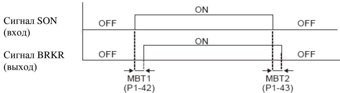
При отключении сигнала SON, сигнал BRKR может быть отключен с задержкой времени P1-43.
