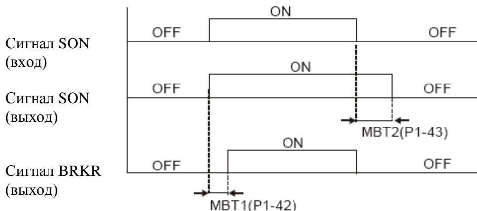
При отключении сигнала SON, и отключении сигнала BRKR (тормоз блокирует вал) серводвигатель отключается с задержкой времени P1-43.
