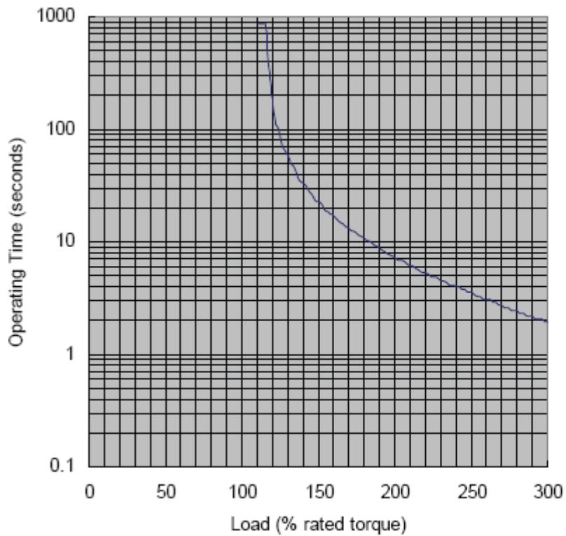
■ Зависимость времени работы от уровня перегрузки (ECMAC31309xS)
