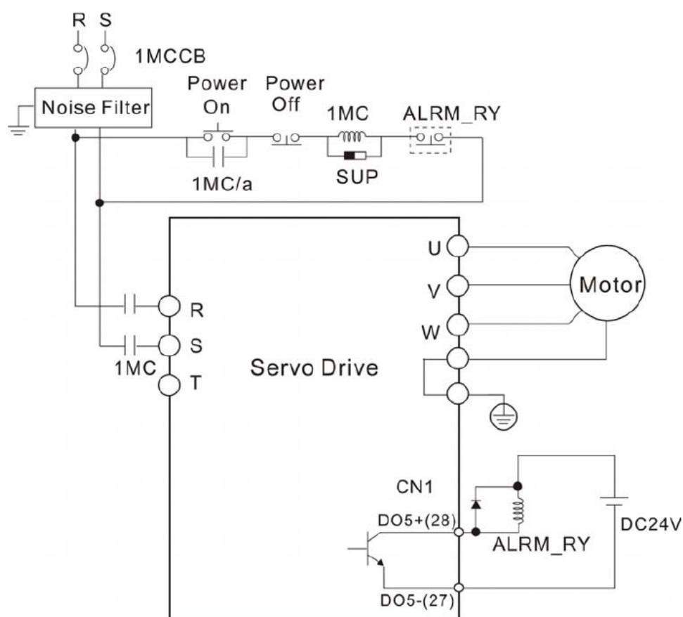
Рисунок 3.3 Подключение 3-х фазного питания.
