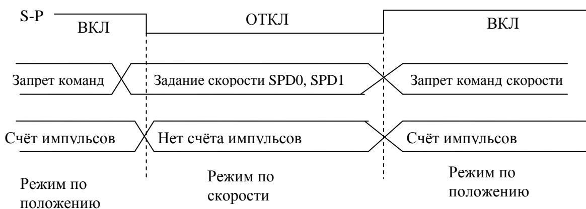
При подаче сигнала S-P, активным становится режим по положению, и двигатель работает в соответствии с входным импульсным сигналом. При отключении сигнала S-P подсчет импульсов прекращается, происходит переход в режим управления скоростью в соответствии с сигналами SPD0, SPD1. После повторного включения сигнала S-P происходит немедленный переход в режим позиционирования.
