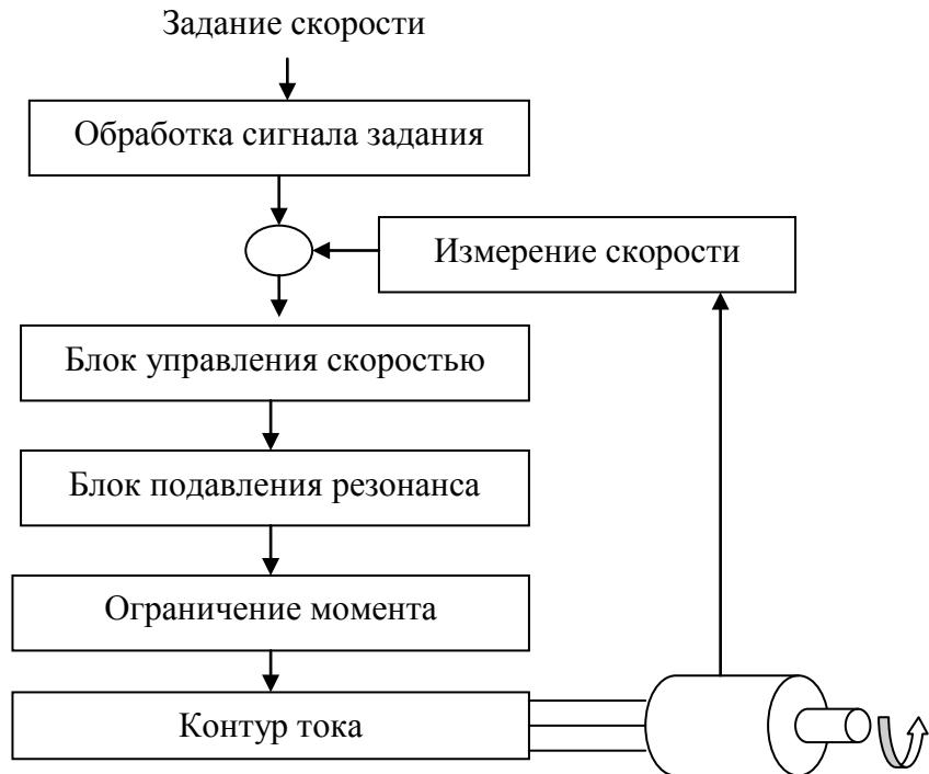
Показанный на общей структуре блок обработки сигнала задания скорости включает выбор источника задания в соответствии с разделом 6.3.1, коэффициент пропорциональности (параметр P1-40) и функцию сглаживания с помощью S – характеристики. Блок управления скоростью предназначен для определения коэффициентов усиления и вычисления необходимого сигнала для контура тока. Блок подавления резонанса обеспечивает устранение резонансных явлений в механической системе.
