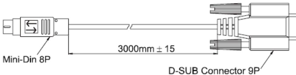
Обозначение Delta: ASDBCACK0001 (для подключения цифрового пульта к компьютеру ).
