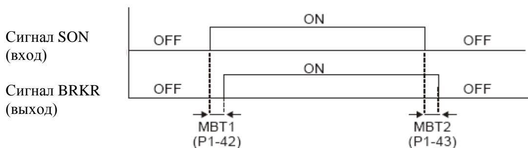
При отключении сигнала SON, сигнал BRKR может быть отключен с задержкой времени P1-43.
