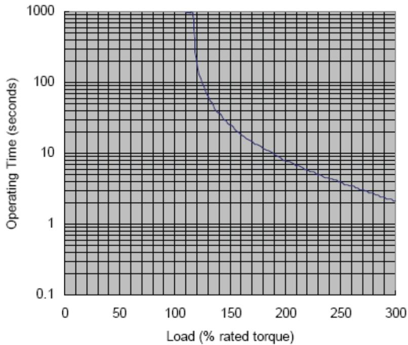
■ Зависимость времени работы от уровня перегрузки (ECMAC31310xS)
