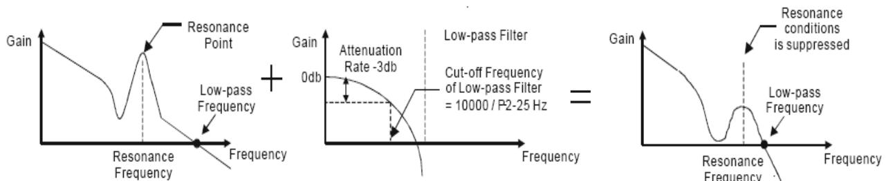
При увеличении постоянной времени НЧ – фильтра значение верхней частоты полосы пропускания уменьшается. Вероятность проявления резонанса также снижается, но уменьшается частотный диапазон полосы пропускания и уменьшается запас по фазе, что может привести к неустойчивости системы. При известной величине частоты резонанса лучше использовать режекторный фильтр для подавления резонанса (P2-23, P2-24). Однако если резонансная частота не постоянна, то лучше использовать НЧ – фильтр.
