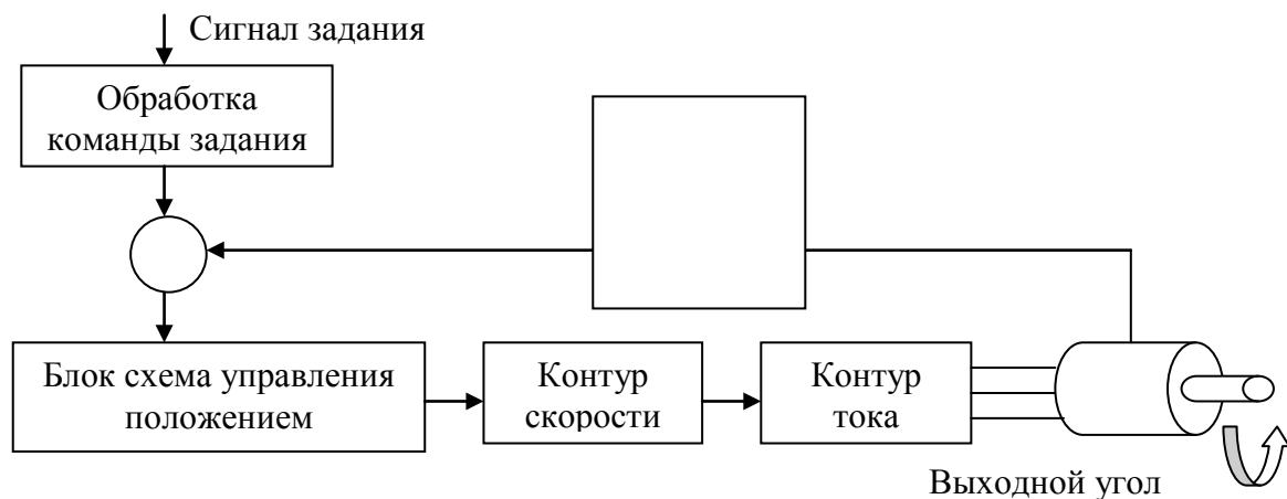
Для обеспечения качественного управления по положению входной импульсный сигнал проходит предварительную обработку. Блок схема обработки сигнала задания показана на следующем рисунке:
