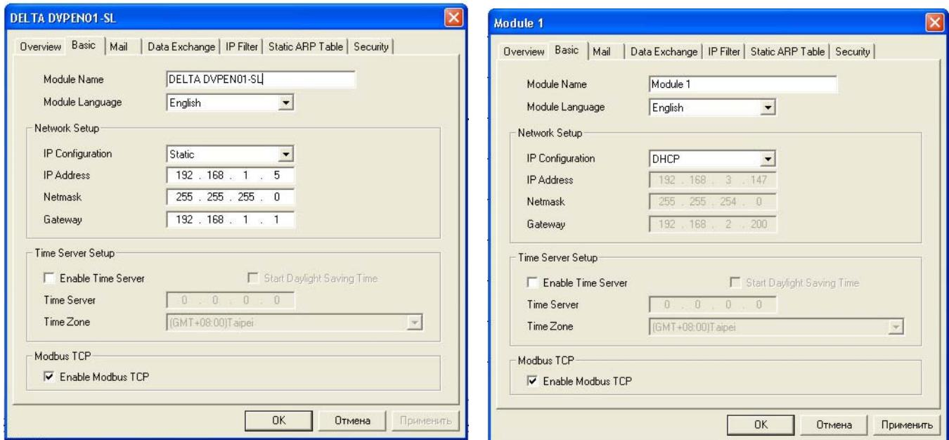
Может сложиться ситуация, что настройки, получаемые автоматически, не будут давать возможности соединиться ПК и модулю, тогда сетевые параметры нужно придется задать вручную. Лучшим способом является ручная настройка с привязкой на сервере к MAC-адресу модуля.
