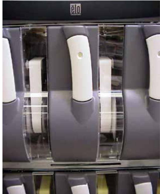
Подвесьте переднюю часть полки для клавиатуры с помощью слота под первым уровнем анализаторов.
