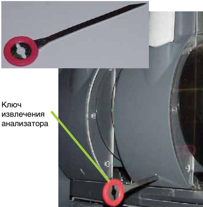
Рисунок 6-3. Расположение ключа извлечения анализатора Vertex и соответствующего гнезда
