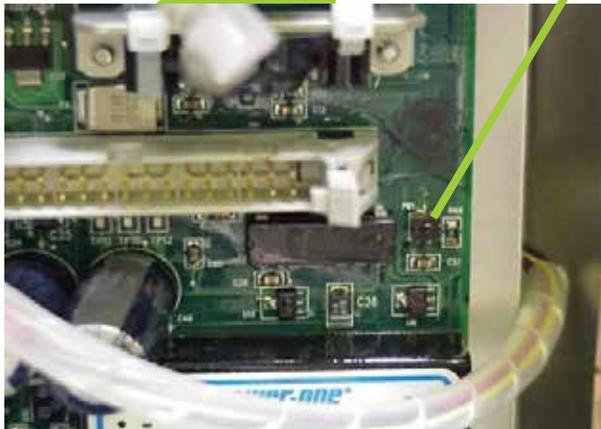
Рисунок 6-1. Расположение кнопки ручного переопределения анализатора Vertex
