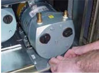
2. Вставьте насос в корпус до упора, чтобы кнопка отсоединения зафиксировалась в нижней части корпуса.
