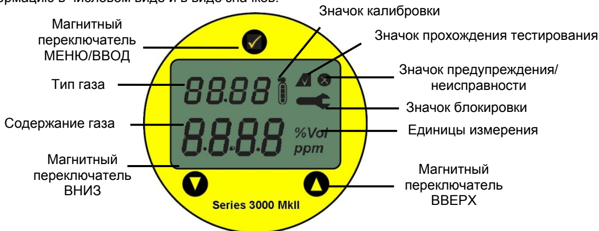
Рисунок 2. Магнитные переключатели и дисплей детектора Series 3000 MkII
