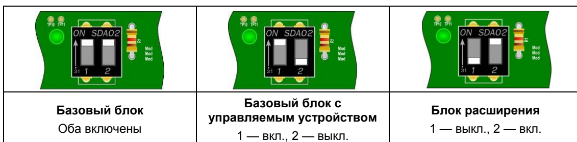
Рисунок 12. Положения микропереключателей на объединительных платах
