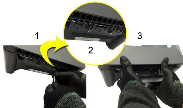
Рисунок 9. Откручивание двух фиксирующих винтов и открытие корпуса
