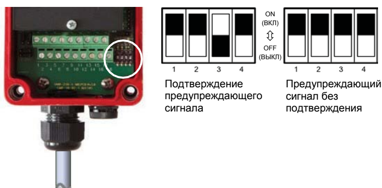
Рис. 15. Параметры подтверждения предупреждающего сигнала
